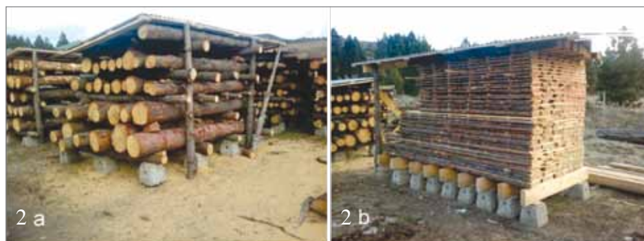
Figura 2. Vistas de las estibas utilizadas para el secado natural. a) Rollizos b) Madera aserrada 4 caras y con canto vivo.
